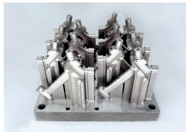
In Flugzeugturbinen wird über mehrere solcher »Fuel Nozzels« Treibstoff eingespritzt. Sie müssen robust sein und hohen Temperaturen standhalten.
